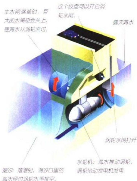
潮汐发电机落潮时的工作原理图
