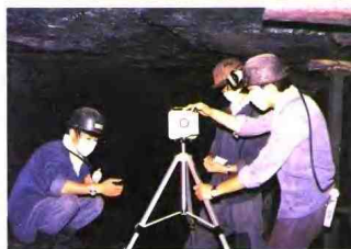
国产 KBC-1 型粉尘采样器采集矿井粉尘浓度
