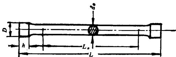
图 1-1 钢的标准拉伸试样图
