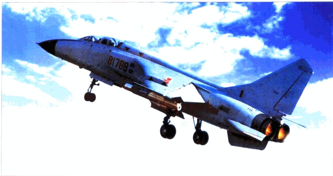
“飞豹”歼击轰炸机是我国自行研制的战斗机。它是既能在空中格斗又能对地面目标进行轰炸的新型战斗机，突防性能好、载重量大、续航能力强。该机长22.3米，翼展12.7米，机高6.6米，最大外挂重6.5吨，飞行速度是音速的1.7倍，作战半径1650千米。
