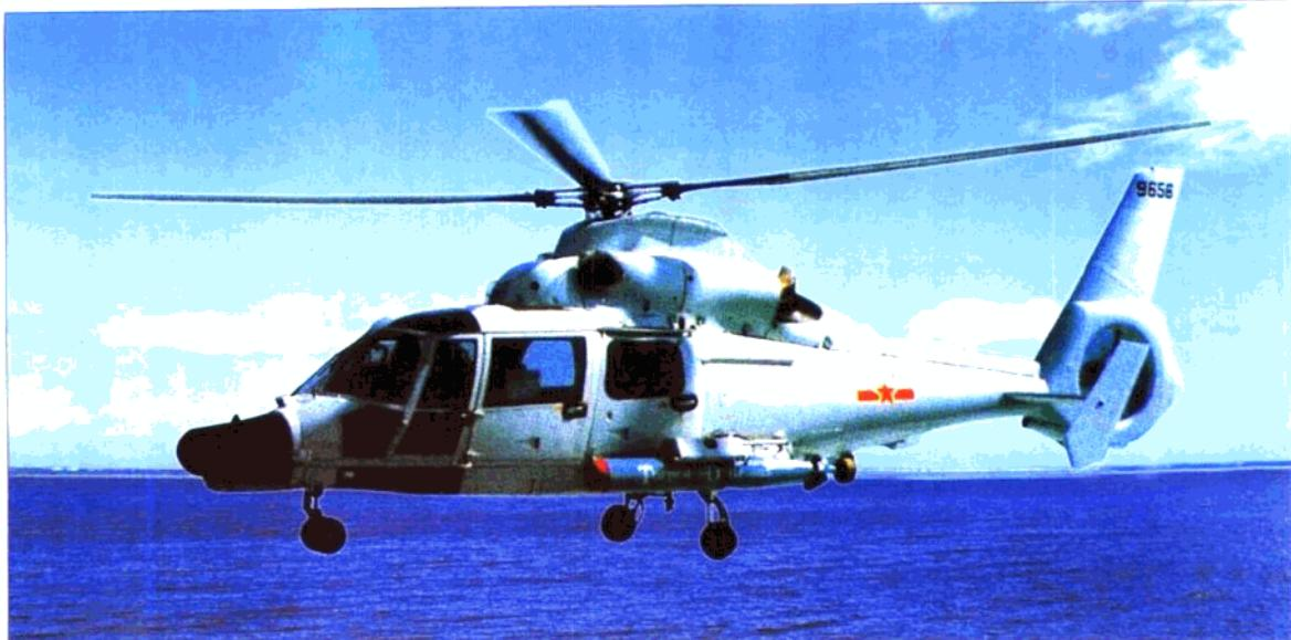
Z - 9武装直升机是我国仿造法国的轻型武装直升机。设计人员在制造时采用了很多新技术，使得Z - 9武装直升机有很好的飞行性能和机动性，最大飞行速度为324千米/小时。它用途广泛，可用于人员运输、近海支援、海上巡逻等，还可以发射导弹及携带反潜鱼雷攻击潜艇。
