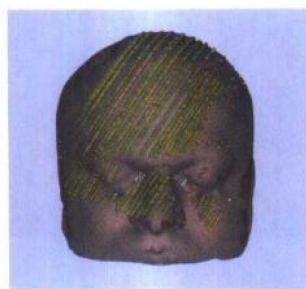
图5-9 激光扫描和配准的结果。小的点是激光扫描的点，在扫描点与三维模型之间的配准精度分别用绿、红和白色表示，相应地在2, 4和4以上
