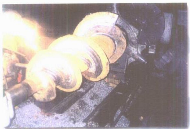
图中为正在加工的大型 \phi 936 锥形双螺杆挤出压片机螺杆 产品规格：螺杆直径：330mm；734mm；936mm
