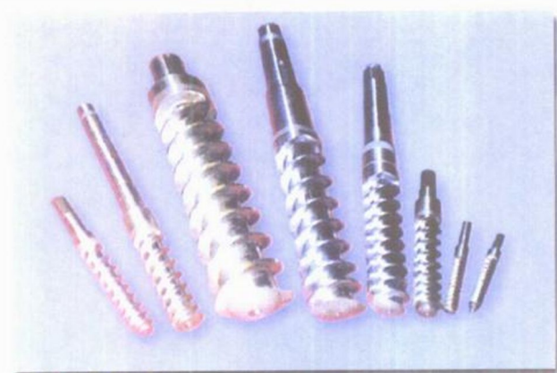
各种橡胶挤出机螺杆及喷涂硬质合金后的螺杆
