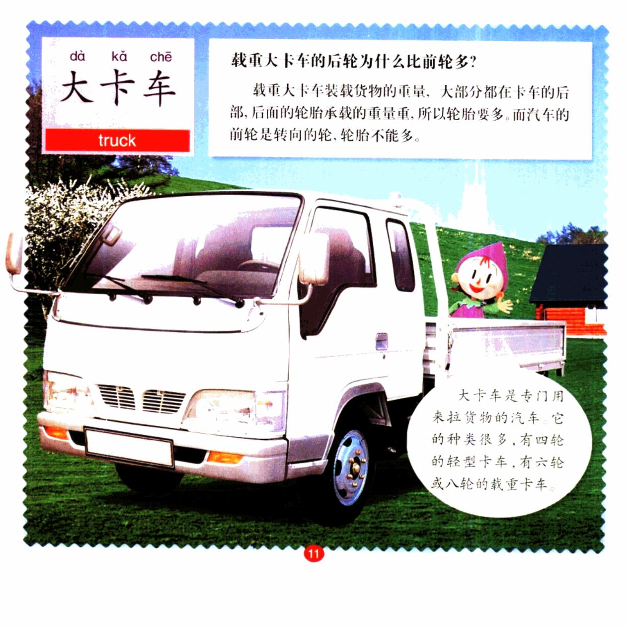
大卡车是专门用来拉货物的汽车。它的种类很多，有四轮的轻型卡车，有六轮或八轮的载重卡车。
