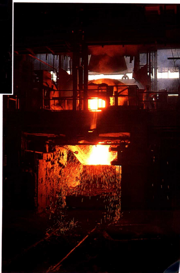
南京钢铁厂15吨氧气顶吹转炉出钢。
