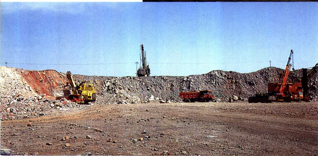
南京白云石矿露天采场，电铲在装车。
