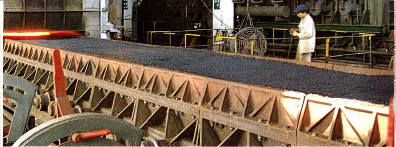
苏州钢铁厂 18 平方米烧结机在生产。
