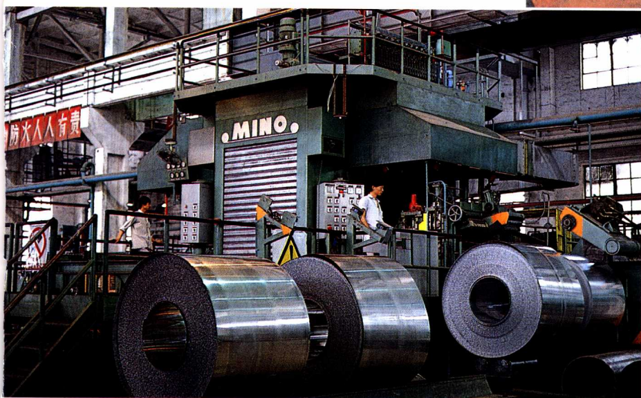
镇江铝加工厂铝压延车间冷轧机。
