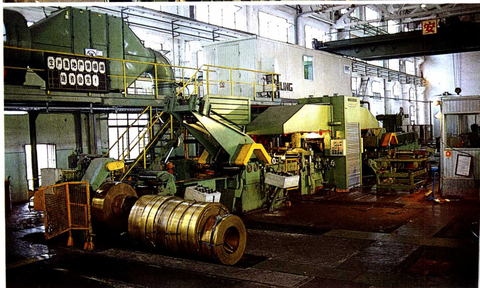
苏州铜材厂四辊可逆冷轧机。
