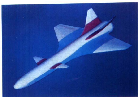
彩图 8 用偏微分方程方法构造机身、翼面间的过渡面 (马岭等, 1997)
