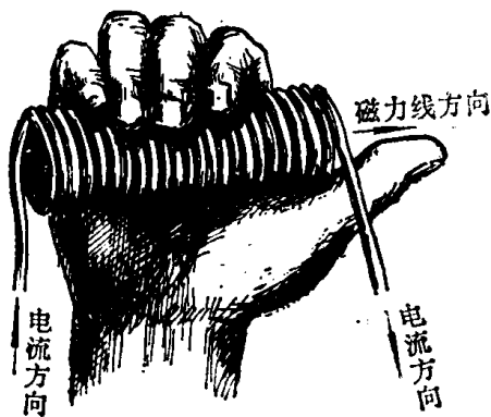
图 1-1-4 螺管线圈右手定则
