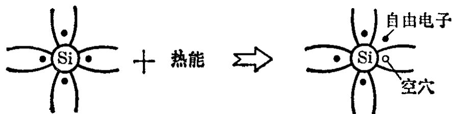
图 6-2 热激励产生的电子空穴对
