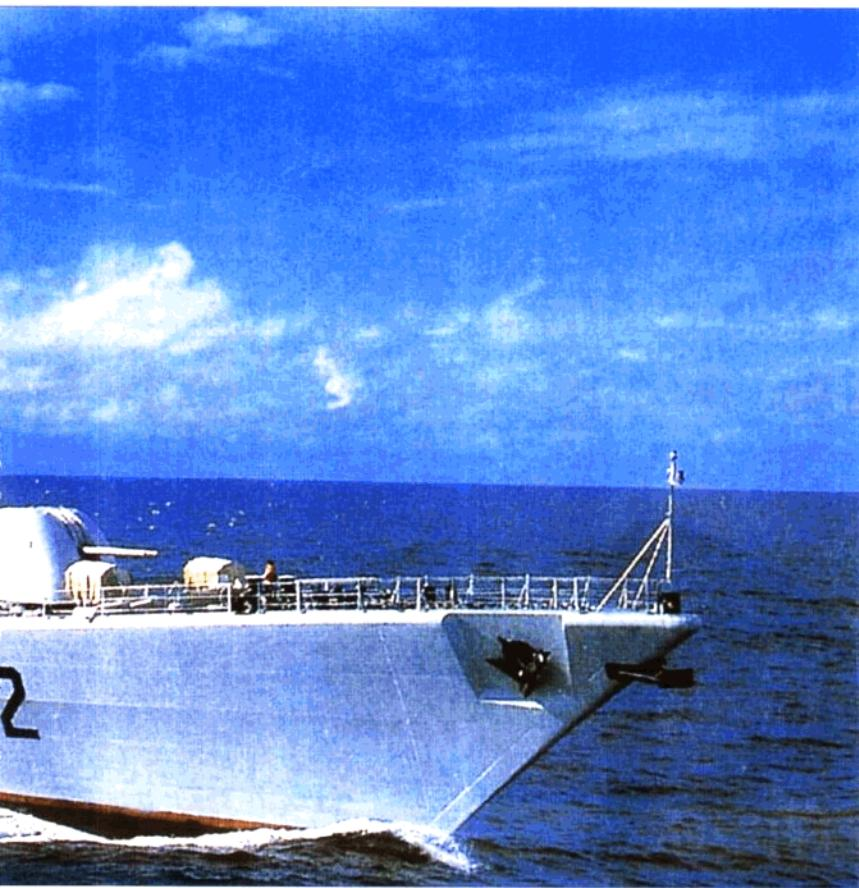
导弹驱逐舰是我国自行研制的新型舰只。舰长148米，舷宽16米，吃水7.5米，舰高40米，满载排水量4800吨。最大航速31节。它的武器系统强大，装备有一座双管100毫米高平两用自动舰炮，一座防空导弹发射装置，两组37毫米自动炮，两座火箭式深水炸弹发射装置，舰艇两侧有鱼雷发射装置，舰上还搭载有两架反潜直升机，它具有很强的防空、反舰和反潜作战能力。1997年3月，112号导弹驱逐舰曾和其它几只舰艇编成舰队，跨越太平洋，对美洲4国进行了成功的访问。
