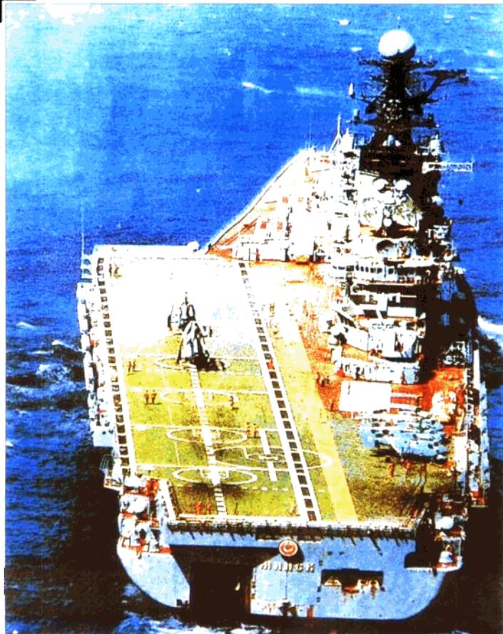
“基辅”级航空母舰长273米，排水量3.71万吨，航速32节。舰上可以搭载垂直起降的战斗机13架，反潜直升机19架，舰上装有4座反舰导弹发射装置。它既具有航空母舰的性能，又具有巡洋舰一样的水上打击能力，所以被人们称为是“全武行”的战舰。
