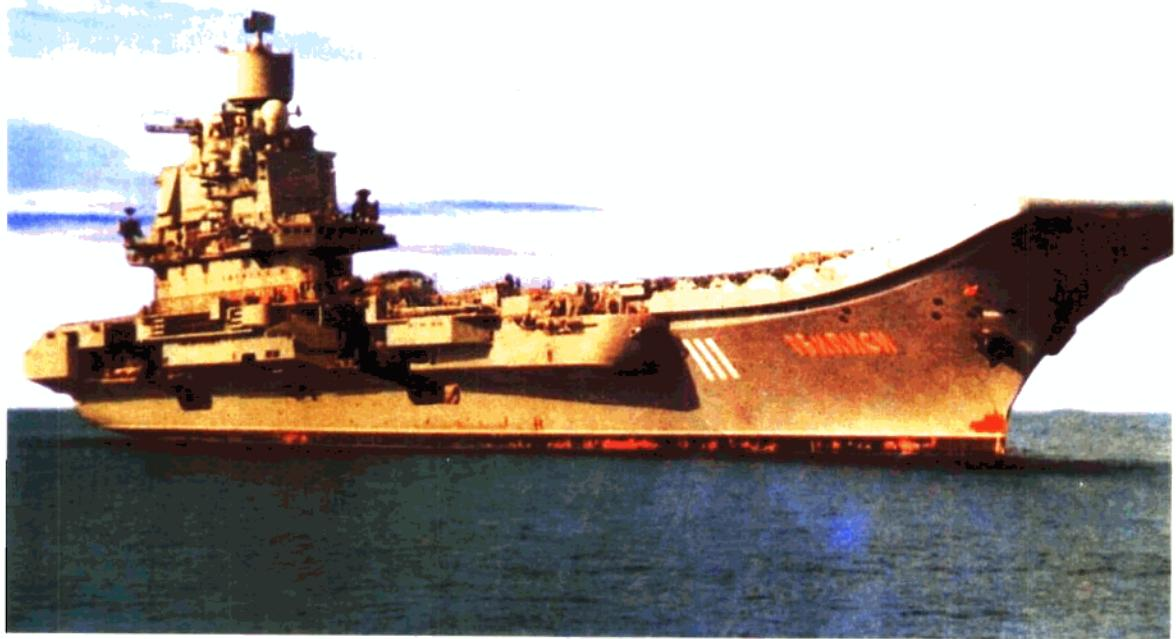
“库兹涅佐夫”号航空母舰建成于1991年，满载排水量为6.75万吨，长304.5米，宽37米，航速30节。这艘航母采用斜直两段飞行甲板，甲板上安装了多道拦阴索和紧急拦机网，可以搭载各型飞机和直升机60架。除此以外，这艘航母上还装载有12具舰舰导弹发射装置和防空炮、反潜火箭及其它武器系统。它是舰载武器最多的航空母舰。
