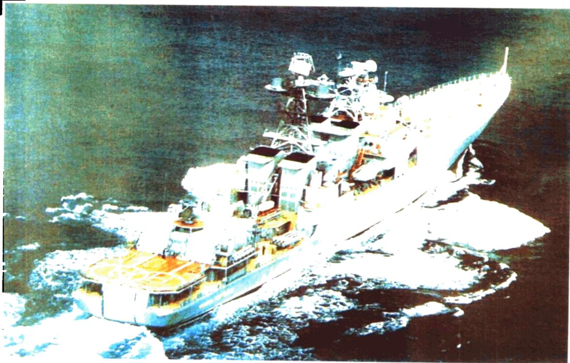
“无畏”级导弹驱逐舰长164米，宽19米，满载排水量8700吨，航速30节，装备有两座反潜导弹发射装置，两个鱼雷发射管，4座近防炮，另外还有两架反潜直升机。它是以反潜为主要任务的驱逐舰，具有很强的打击潜艇的能力，如果航空母舰用它来护航，潜艇是很难靠近的。
