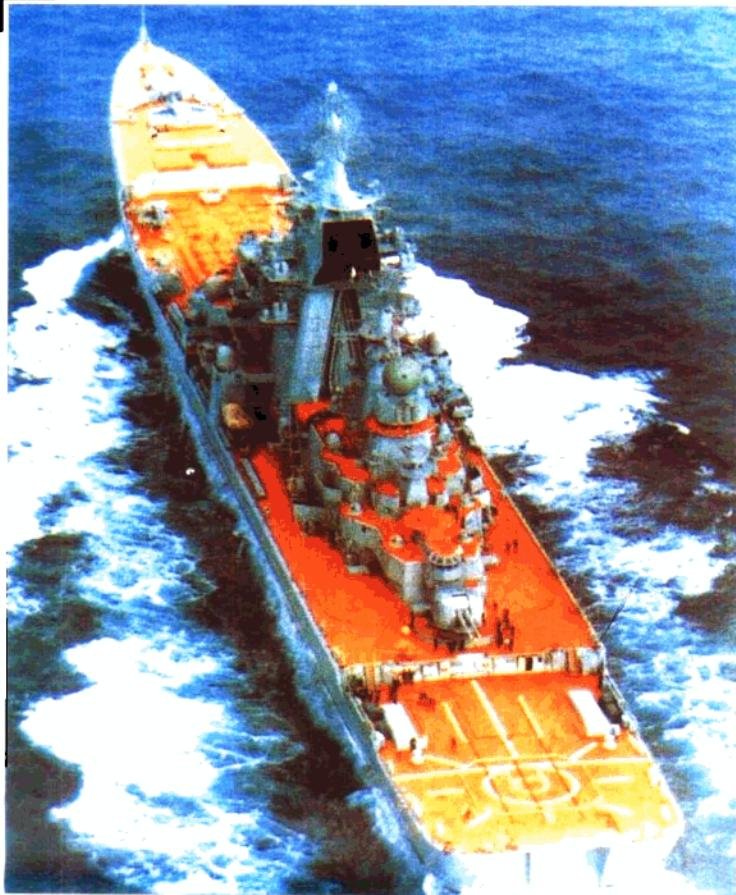
“基洛夫”级巡洋舰长248米，宽28米，吃水8.8米，标准排水量2.7万吨，满载排水量3.2万吨，航速32节。它是世界上吨位最大、装备武器最多的巡洋舰，也是第一艘装备了垂直发射系统的水面舰艇。舰上装有20座反舰导弹，28座垂直发射防空导弹装置，一座130毫米火炮，6座导弹火炮合用发射装置，2个五联装鱼雷发射管，3架直升机，还载有近200枚导弹，可以称得上是一个漂浮在海上的武器库。
