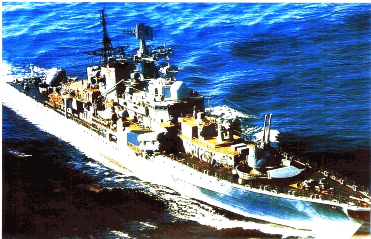
“现代”级导弹驱逐舰长156米，宽17米，排水量7500吨，航速32节，装备有2座反舰导弹发射架，2座防空导弹发射架，2座130毫米炮，4个鱼雷发射管和一架直升机。它能发射远程超音速反舰导弹，连航空母舰也得让它三分。
