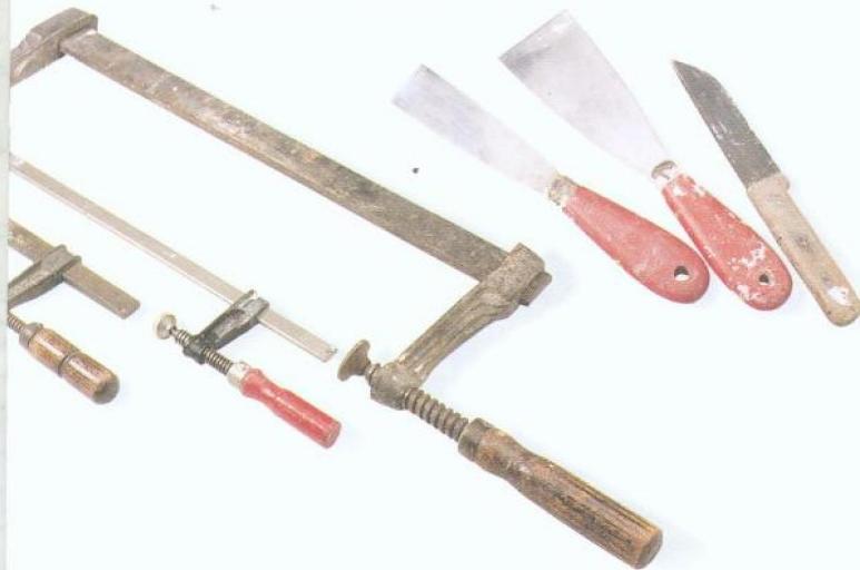
**螺旋夹具** 由方形的钢条组成，一端可拧紧，夹住模型。要固定方形模型的铸箱，它们是必不可少的。
