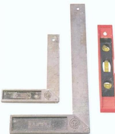
**矩尺、水平仪** 矩尺为金属、木或塑料质工具，两边成90°角，且一边上标有刻度。矩尺可保证坯体垂直放置，或者用来校准石膏模型的铸箱是否垂直。
