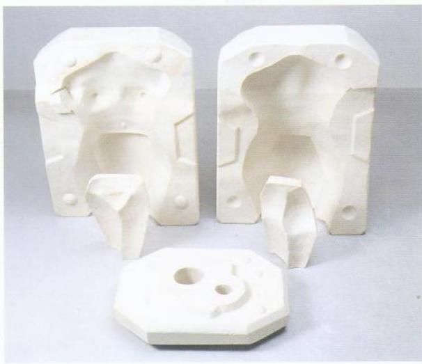
让其再变硬一些。假如开模过早，坯体会破裂。当坯件脱模后，刮除模缝边上多余的泥料。可在坯体半干时、干燥时、甚至素烧后将模缝痕刮除。
