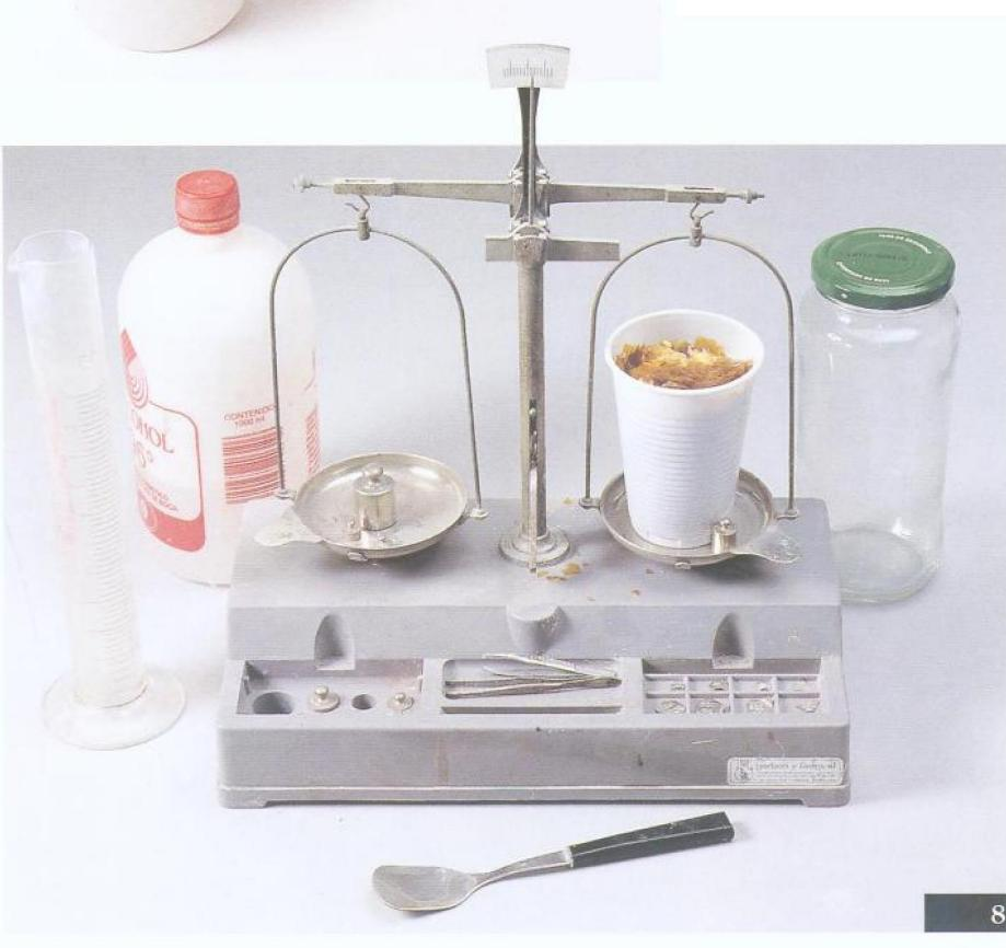
8. 用精密天平称出洋干漆，并量出适量的酒精。将酒精倒入一个瓶子中，然后加入洋干漆。盖上瓶盖，在至少两个小时的阶段内间或摇动瓶子，使洋干漆易溶解。洋干漆完全溶于酒精后才能使用。涂抹洋干漆酒精溶液的画笔用后必须依次用甲醇、肥皂、清水进行清洗。装溶液的瓶子应密封，避免酒精挥发。
