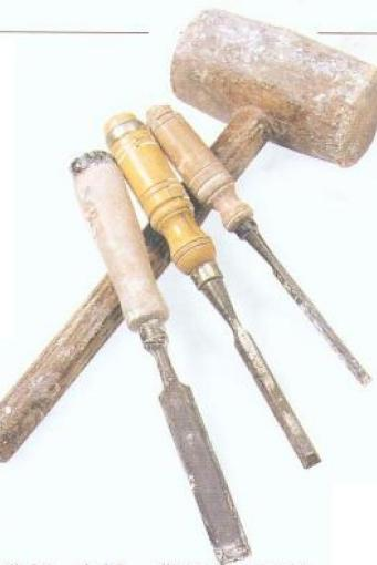
**凿子、木槌** 凿子由扁平状的长方形钢片制成，长约15cm，宽为5mm—40mm。一端磨尖，呈20°—30°角的斜面，另一端插在木或塑料
