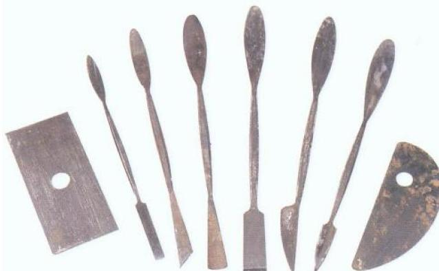
**雕塑刀** 这些工具由木把手顶端装上被弯曲成特定形状的金属丝或金属片制成。雕塑刀可用于挖空由实心泥团塑造的坯体，挖出反转模技法中用到的原型，以及掏出由印坯模制作的面砖背面。圆头的雕塑刀可用于挖出石膏模的榫孔。
