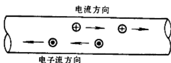
图1-5 导线中的电子流方向和电流方向
