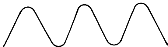
图 1.1.4 场扫描脉冲的波形
