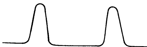
图 1.1.6 场逆程脉冲的波形
