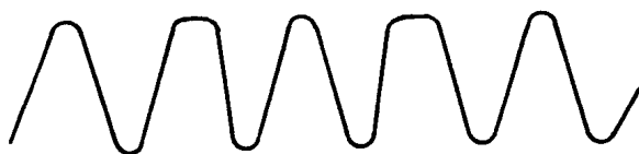
图 1.1.2 行振荡电路产生的扫描脉冲的波形
