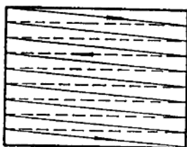
图 1—4 逐行扫描示意图 图 1—5 场扫描逆程示意图
