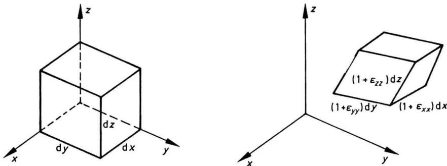
Abb. 9.1.1 Ein infinitesimales Volumenelement im nichtdeformierten und deformierten Zustand
