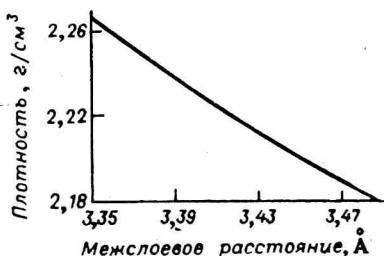
Рис. 2.1. Зависимость рентгенографической плотности графита от среднего межслоевого расстояния.
