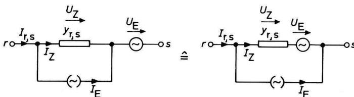
Bild 1.1.2. Äquivalente Ersatzbilder von Zweipolzweigen mit starren Quellen
