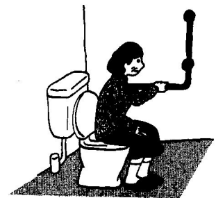
L型手すり
