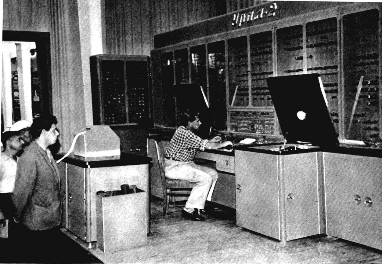
10. Электронная вычислительная машина «Урал-2», с ее помощью решаются самые сложные математические и логические задачи. Машина может сыграть партии в шахматы и шашки, составить план формирования поездов, решить задачу нахождения оптимального плана перевозок, а также производить другие инженерно-технические расчеты.
