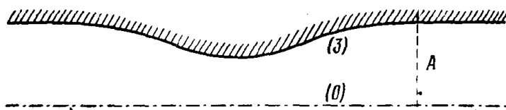
Фиг. 4. Сопло Лавая. A — разделяющая плоскость.
