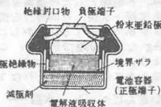
亜鉛粉末を使用した水銀電池の一例
