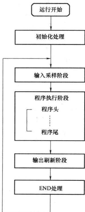
图 1-6 PLC 的工作过程
