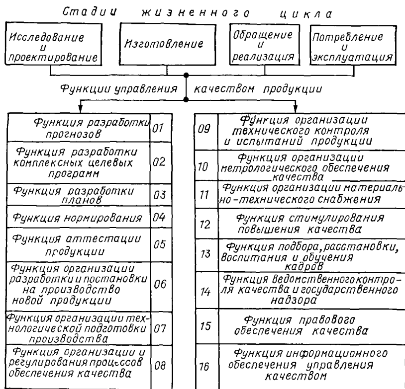
Рис 1 Функциональная структура системы управления качеством
