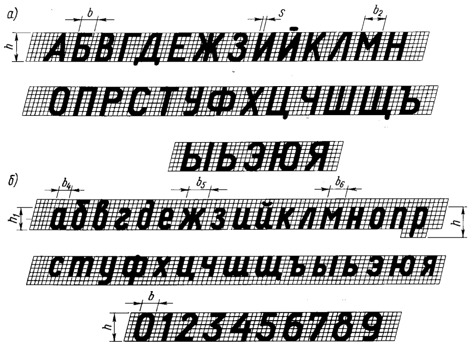
Рис. 6. Основной шрифт с наклоном: а — прописные буквы, б — строчные буквы, в — арабские цифры
