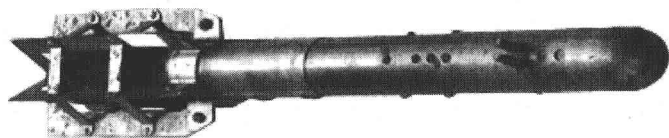
图 2-2 阿瑟斯坦·斯比尔霍斯发明的温深测量仪
