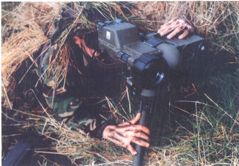
英国生产的炮兵观测瞄准器,由热成像器和激光测距仪结合在一起。
