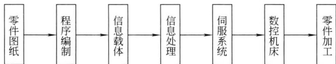
图 1-2 数控程序加工过程示意框图
