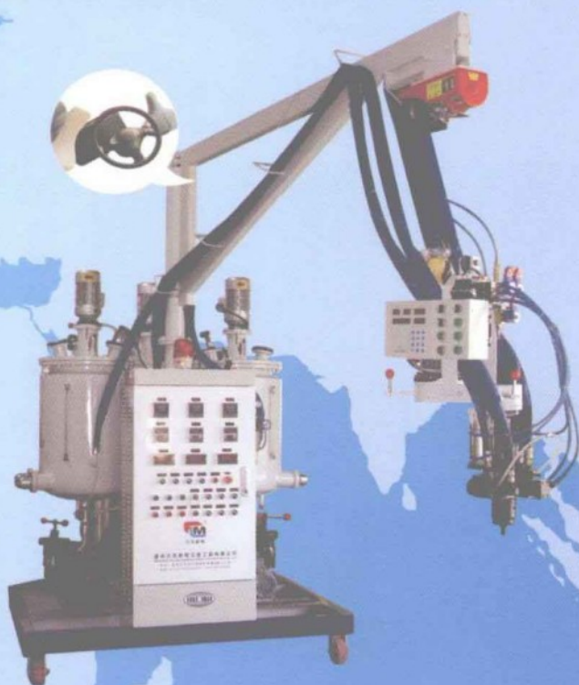
PU30F-R 三组份聚氨酯发泡机 PU30F-R TRI-GROUP POLYURETHANE FOAM MACHINE
