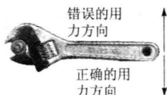
图 1-9 扳手的用力方向
