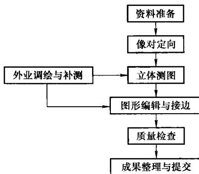
先测图后野外调绘的工作流程：
