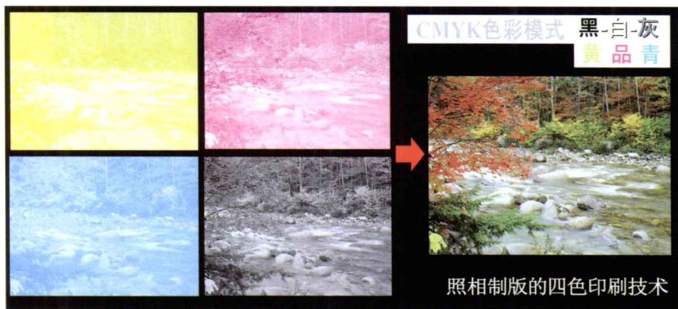
图 0-1-9 四色印刷术原理
