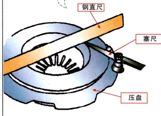
图1-22 压盘翘曲度的检查
