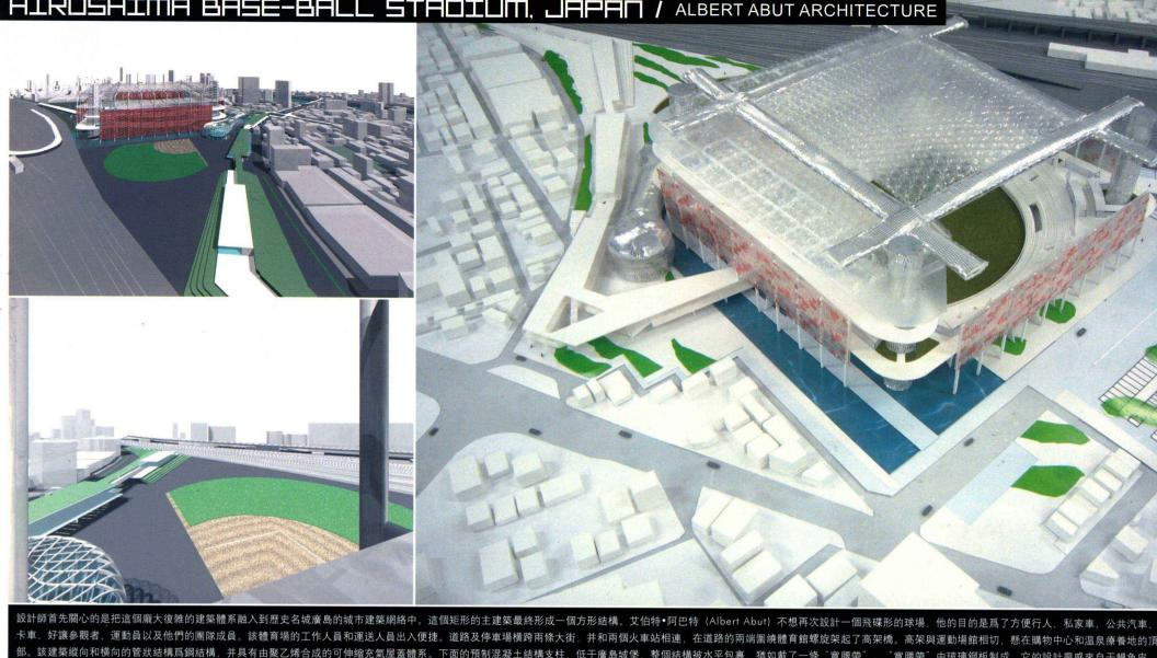
卡車,好讓參觀者、運動員以及他們的團隊成員。該體育場的工作人員和運送人員出入便捷。道路及停車場横跨兩條大街,并和兩個火車站相連,在道路的兩端圍繞體育館螺旋架起了高架橋。高架與運動場館相切,懸在購物中心和温泉療養地的頂 部。該建築縱向和横向的管狀結構爲鋼結構,并具有由聚乙烯合成的可伸縮充氣屋蓋體系。下面的預制混凝土結構支柱,低于廣島城堡,整個結構被水平包裹,猶如戴了一條"寬腰帶"。"寬腰帶"由玻璃鋼板制成,它的設計靈感來自于鯉魚皮。 當眼前的建築讓你想到廣島的"鯉魚"棒球隊的時候,你就置身于廣島棒球場了。
