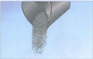
为了能够将混凝土注入已备好的木质模板中，混凝土必须柔滑。
