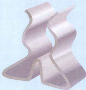
图为一种塑料隔件，它像夹子一样夹住钢筋，防止钢筋掉到模板的底部。
