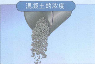
混凝土的浓度 为了能够固定路面中的石子，混凝土应具备一定湿度。
