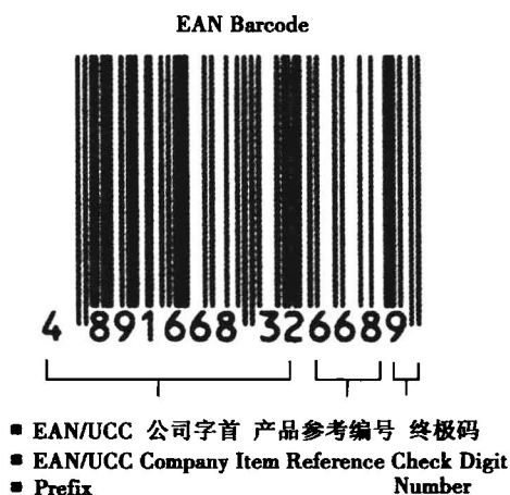
图 1-1 使用条形码识别被包装的产品
