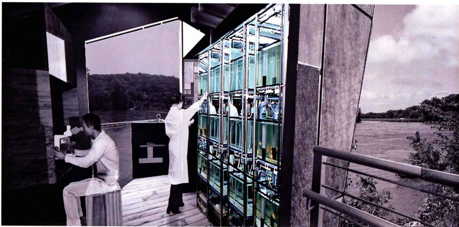
工作间：从研究站的渲染图（上图）上可见水测试设备和一些毒理学研究必备的容器，以及计算机/工作站。将钢格栅门（左图）打开后靠墙锁止，它就巧妙地形成一个烧杯搁架。
