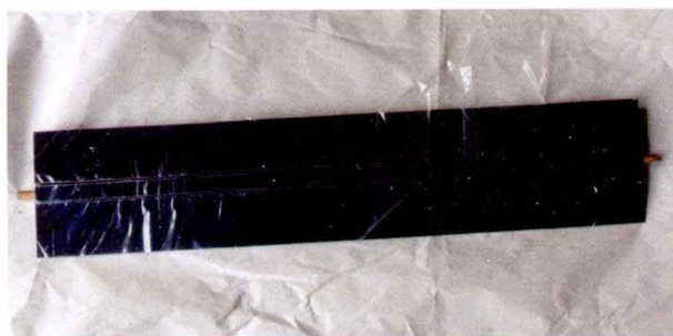
图2-14 蓝膜太阳能吸热板芯
