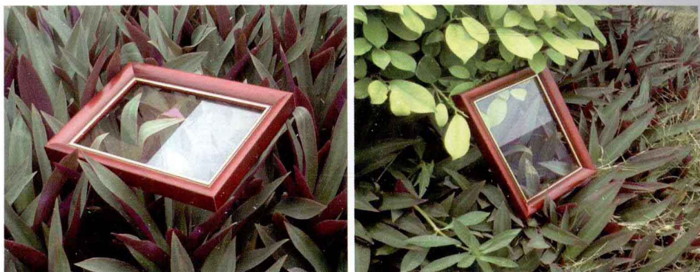
图4-15 减反射薄膜的效果照片
