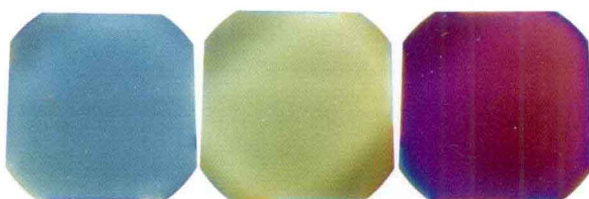
图4-38 沉积不同厚度的氮化硅获得的颜色
