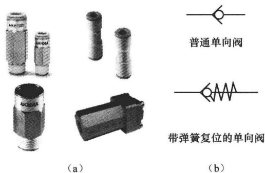
图 1-6 单向阀的外形与图形符号 (a) 外形;(b) 图形符号
