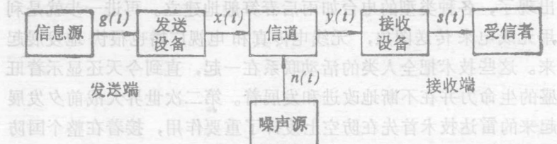
图1.3 通信系统的一般模型
