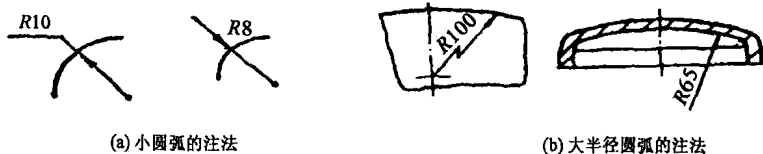
图 1-4 半径尺寸的注法
