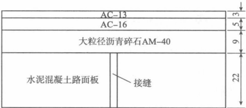
图 1-6 某试验路设置的大粒径沥青碎石中间层加铺层结构(尺寸单位:cm)
