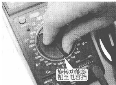
图 1-26 调整电容检测挡
