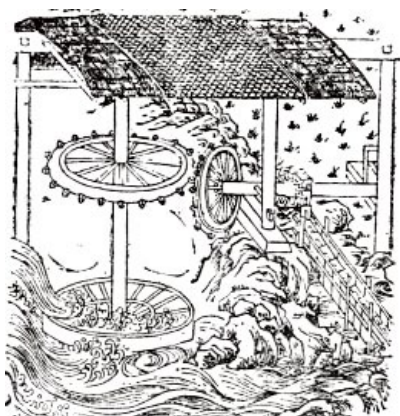
图1-3 高转筒车（左）和水利筒车（右）。图片采自《图书集成》
