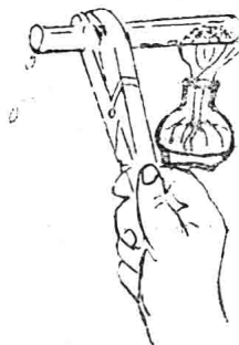
图2 用试管加热潮湿的固体
