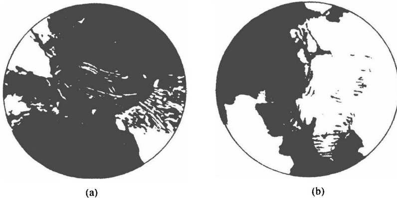
图 1.1 岩石薄片石英晶粒内放大 100 倍的宏观残余应力场 (a) 和晶粒边界放大 40 倍的微观残余应力场 (b) 的显微光弹性等色线照片
