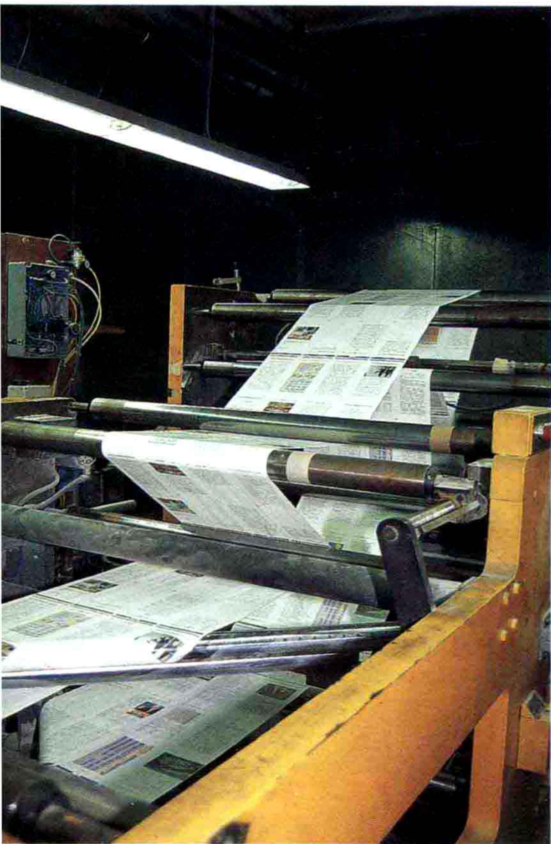
以现代化的 辊式胶印机 印刷“德国 概况”
