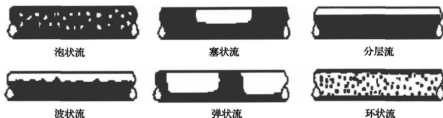
图 1-2 水平流动管道中的流型
