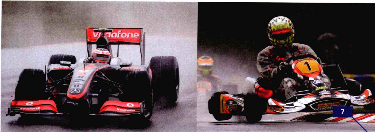
卡丁转向盘没有助力，F1采用助力转向
